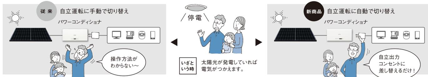
※6. 1500Wが上限です。屋内用パワーコンディショナはコンセントを搭載しています。コンセントの位置は機種によって異なります。屋外用パワーコンディショナの場合は、自立運転コンセントを屋内に設置できます。配線工事が必要ですのでパワーコンディショナを設置する際、工事店にご相談ください。 ※7. テレビ視聴にはブースタ等の周辺機器にも電源が必要な場合があります。 ※8. 自動切替には、予め設定が必要です。屋外用マルチストリング型パワーコンディショナ 品番:VBPC246B3、VBPC259B3等は停電時、自立運転への切替は手動のみです。
