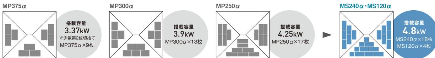
[建物条件] ●寸法8480×7570mm ●スレート屋根 ●勾配4.5寸 ●ケラバ控え300mmの場合
