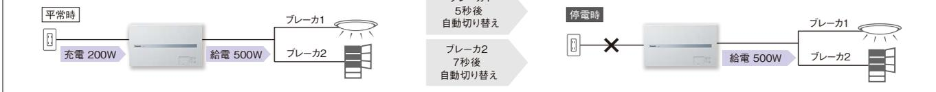
場合があります。 ※8.確実にアース接続できるように、接地極付コンセントが必要です。接地極付コンセントは単独でご使用ください。(プラグは付属しています。) ※9.●太陽電池からの充電は停電時のみ可能です。太陽光発電システムから蓄電盤に入力できる電力は約180Wです。●接続している負荷によっては、太陽光発電システムからの電力を蓄電盤に充電できない場合があります。約120W以下の負荷が目安です。●停電時、蓄電池残量ゼロまで放電すると太陽光発電システムの発電が開始しても充電しない場合があります。この場合は復電するまでお待ちください。●太陽光発電が少ないとパワーコンディショナが止まる場合があります。●10.本機はUPS(無停電電源装置)ではありません。タイマー切換え時にテレビの画像が途切れたり、接続機器が停止する場合があります。●11.冷蔵庫はブレーカ2に接続してください。冷蔵庫と蓄電盤の接続保護のため停電が発生してから約7分間は給電停止状態になります。
