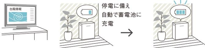
\*1. 停電時、スタンドアロンタイプ(品番:LJSF35)は約5秒後に、リチウムイオン蓄電盤(品番:LJ-SJ10A)のブレーカ1は約5秒後に、ブレーカ2は約7分後に蓄電池給電に切り換わり、接続機器にのみ給電されます。平常時、スタンドアロンタイプ タイマー設定時は数秒以内に蓄電池給電に切り換わり、接続機器に電力が給電されます。リチウムイオン蓄電盤単体から放電したい場合は手動で蓄電池給電に切り替えることが可能です。ただし給電を終了する場合も手動操作が必要です。\*2. AiSEG2対応には、別売の蓄電池ネットアダプタ、AiSEG2(7型モニター機能付)/AiSEG用エネルギー計測ユニットが必要です。停電時にモニターを表示させるにはAiSEG2(7型モニター機能付)、ルーター(市販品)、蓄電池ネットアダプタを蓄電池と接続する必要があります。スタンドアロンタイプ(品番:LJSF35)と接続する場合は、蓄電池ネットアダプタは不要です。\*3. ECHONET Liteはエコーネットコンソーシアムの商標です。
