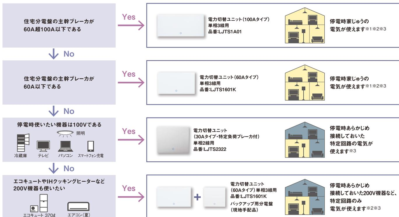
※1.分電盤の主幹ブレーカーをご確認ください。品番:LJTS1A01は100A以下、品番:LJTS1601Kは60A以下の場合に限ります。※2.200Vトランスユニット(パワーステーションS+用・4kVA・据置)(品番:LJTR241)の設置が必要です。※3.停電時のご使用機器全体の消費電力がシステムの自立出力より大きい場合は運転を停止します。
