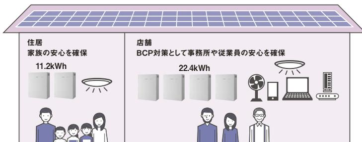
注1) 22.4kWhにはパワーステーションS+(本体)2台、パワーステーションS+(蓄電池用コンバータ)4台、蓄電池ユニット(蓄電容量:5.6kWh)4台、ネットリモコン(パワーステーションS+用)1台が必要です。
