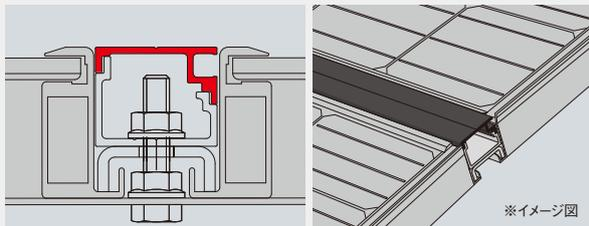
上下のモジュールの間にカバーを設置することでスッキリとした印象に仕上げます。※化粧カバー・スリムカバー、モジュール間カバー、モジュール間雪止めはオプション品(別売)です。
